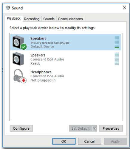
3. Chcete-li změnit zdroj výstupu zvuku, klikněte pravým tlačítkem na výchozí zvukové zařízení a potom klikněte na „Disable“ (Zakázat). Výchozí zvukové zařízení se přepne na další výstupní zvukové zařízení. Chcete-li jej přepnout zpět, klikněte
