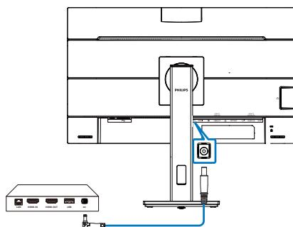
1. Připojte port DC OUT tohoto monitoru k mini PC Intel NUC nebo jinému kompatibilnímu zařízení.
