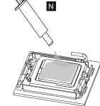
Applying too much thermal paste will lower heat conductivity and cooling performance! 注意:散热膏涂抹过多会降低热传导性能与散热效能。 注意:散熱膏塗抹過多會降低熱傳導性能與散熱效能。
